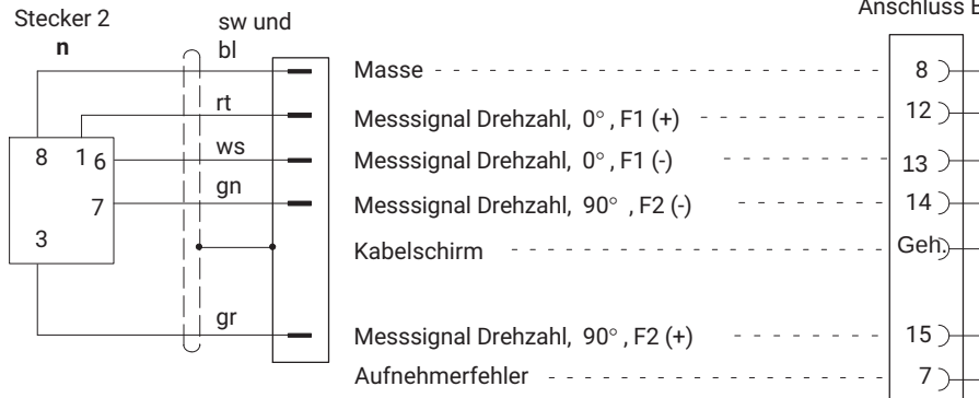
Abb. 6.3 Anschluss MP60
