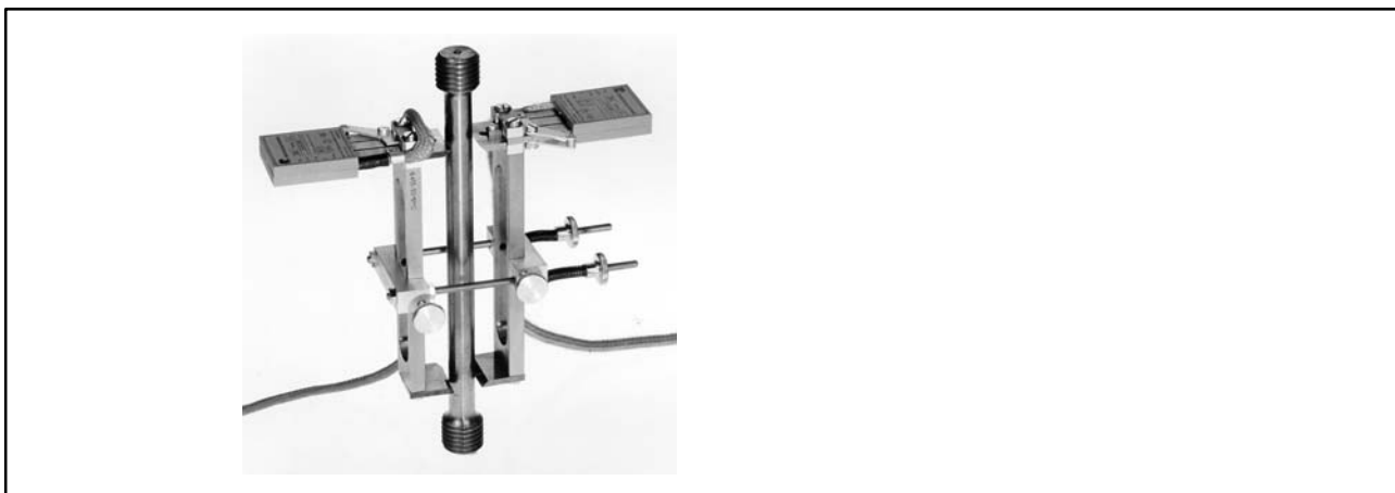
Abb. 3.2: Zwei gegenüberliegend angeordnete Anklemm-Dehnungsaufnehmer DD1 ZA
