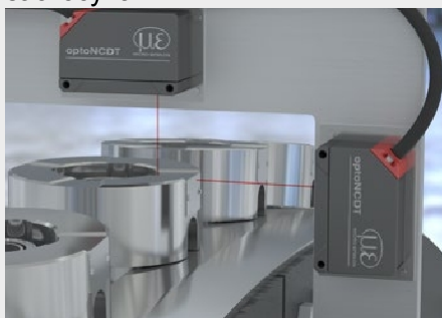
Контроль розмірів точених деталей
